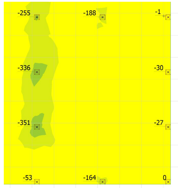
Figur C5 Platefelt P2: Felt og støttemomenter i x-retning skrevet ut enkeltvis
