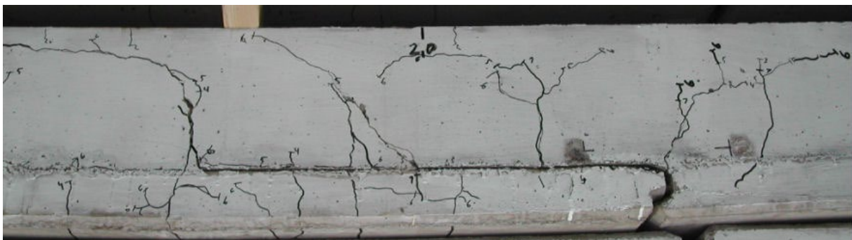
Figur D23 Dimensjonering ved prøving. Illustrasjon av bruddmekanisme 6 [44] Prøvestykke uten endeforankring (bøyle).
