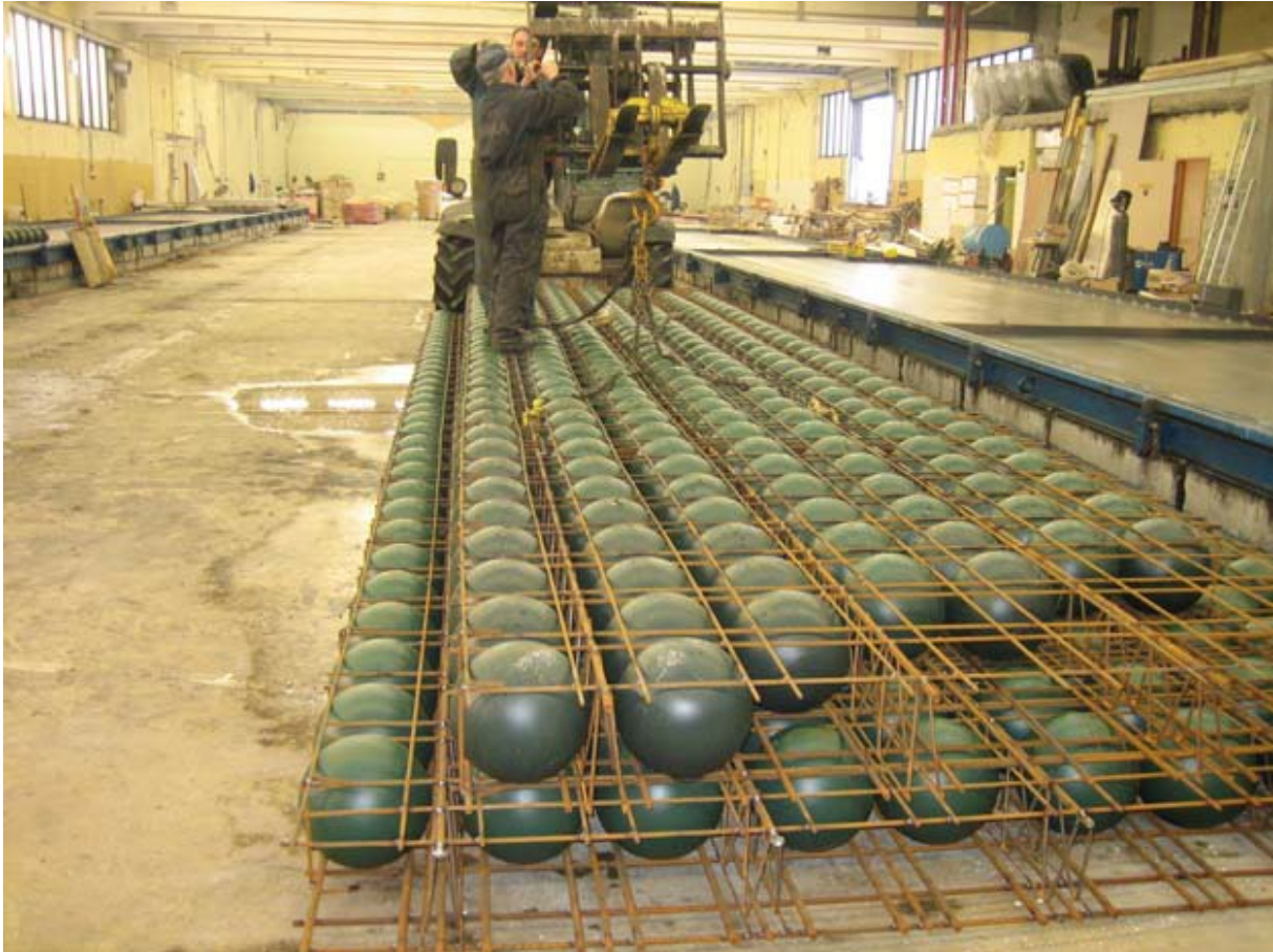
Figur A3 Fra produksjon av BD elementer i fabrikk
